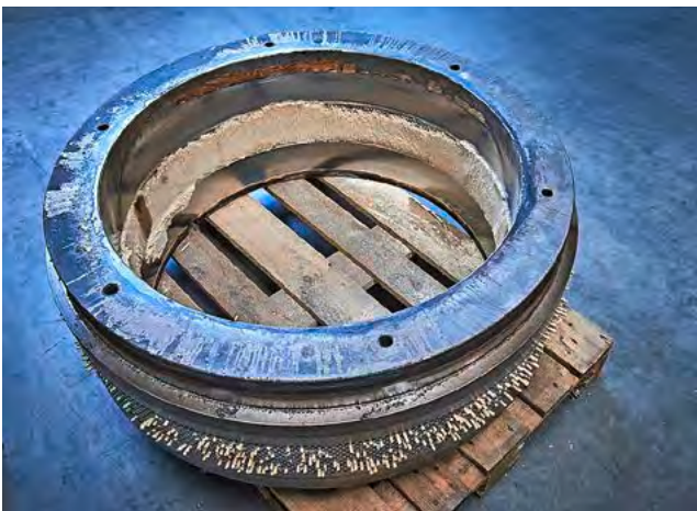
Mit Druck wird das Holzmaterial durch eine Matrice gepresst.
