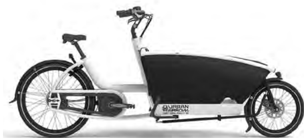
«Urban Arrow» von Smart Urban Mobility Das Rahmenvorderteil mit Box ist austauschbar. So kann etwa das Familienmodell (ab circa 5000 Fr.) bei Bedarf in ein Kurier-Cargo-Bike umfunktioniert werden.
