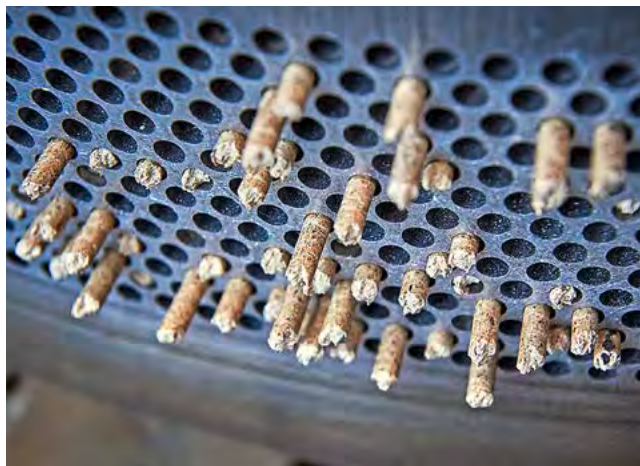
Drei bis vier Zentimeter lang sollte ein ideales Pellet sein.
